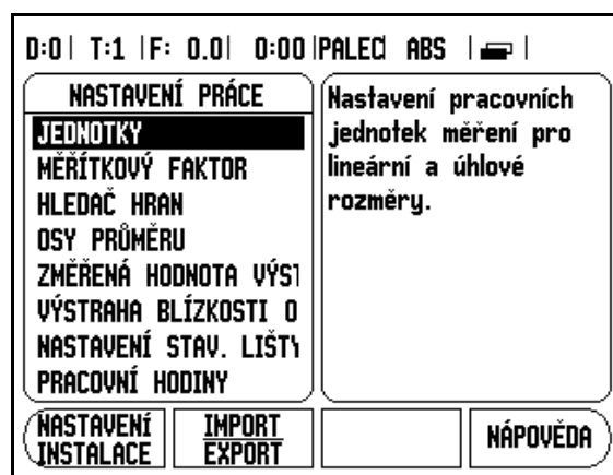
obr. I.3 Obrazovka Nastavení práce při frézování
