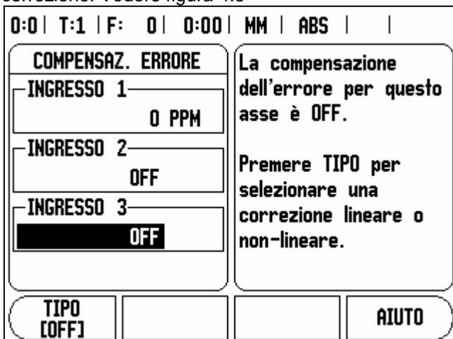
fig. 4.5 schermo compensazione errore di misura
